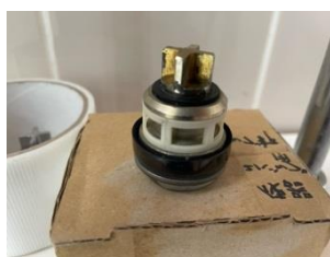
破損したフラッシュバルブ
