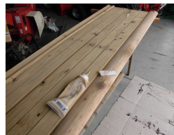
座板 ひび割れ パテ埋め
