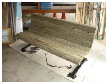
座板取付け完了状況
