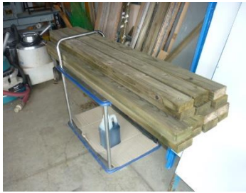
ACQ 加圧注入杉材 13 本使用
