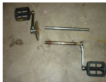
クランクシャフト取り外し
