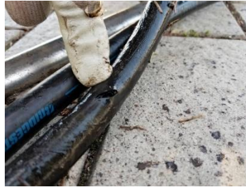
高圧ホース取外し 破損状況
