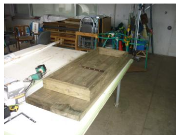
台輪・座板組立て
