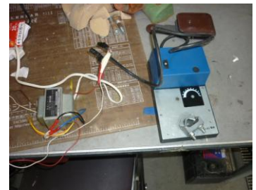
仮設電源で試運転
