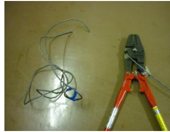
ウインチ引掛け側 解れ切断
