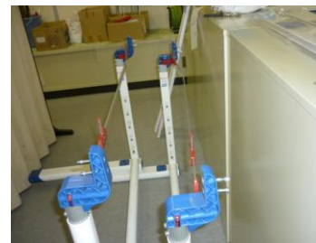
分解 内部アルミバー変形
