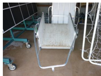
ハンドル・合板取付け完了
