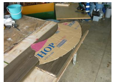
型板取り・座板加工
