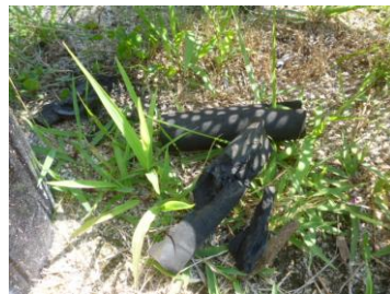
破損して脱落した ゴムスプリング
