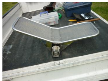
ゴムスプリング取替え完了
