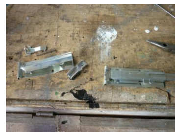
破損ラッチ部取外し
