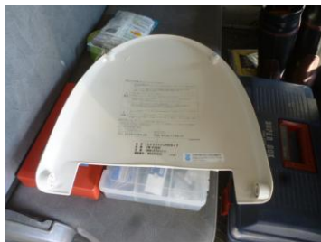
蓋中央にヒビ割れがあった
