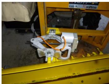
電動ジャッキ取付け完了
