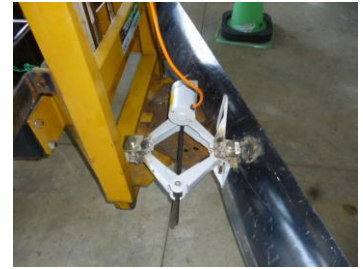
電動ジャッキ取付け調整
