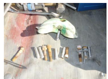
取外したホールアンカー・ボルト
