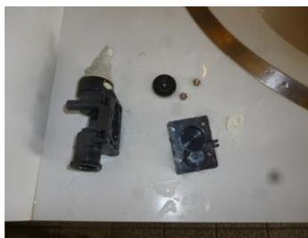
電磁弁分解点検
