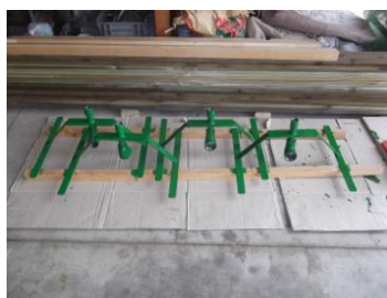
SP 散水用架台製作・塗装工事
