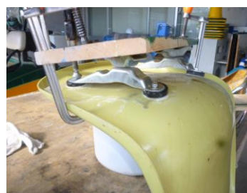
ゴム部接着修理
