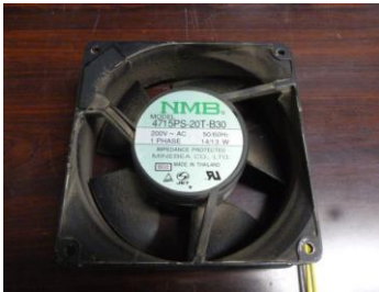
ファン取外し、点検
