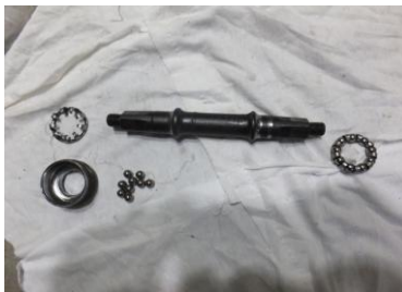
ベアリング破損
