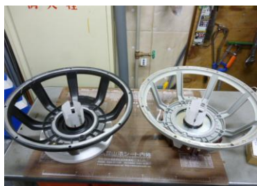
コーン部取り外し・清掃
