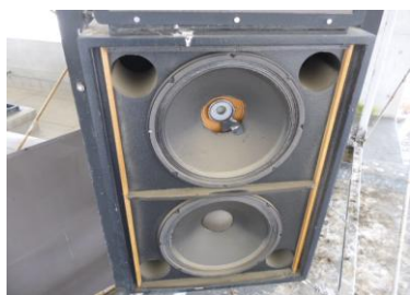
ウーファー破損状況
