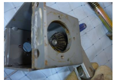
内部ギヤー点検
