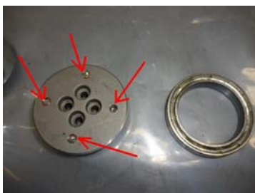
矢印部でネジが断裂している
