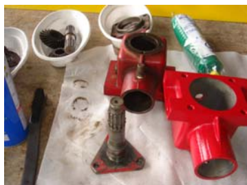
破損したギアBOXと新品
