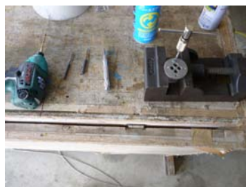
修理状況(タップ立)
