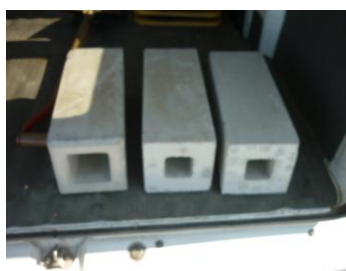
コンクリート基礎部分
